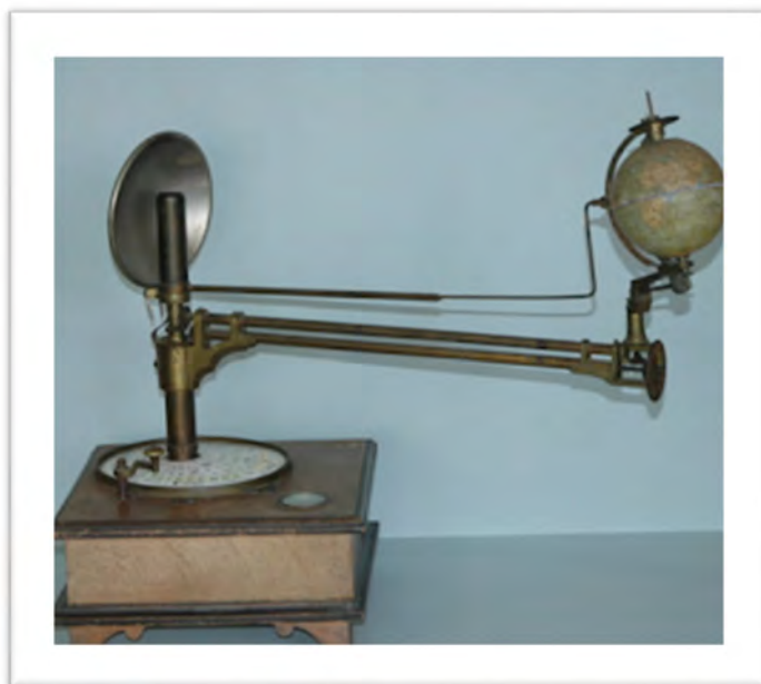
Aparelho para simular o movimento orbital do Sol, Terra e Lua
